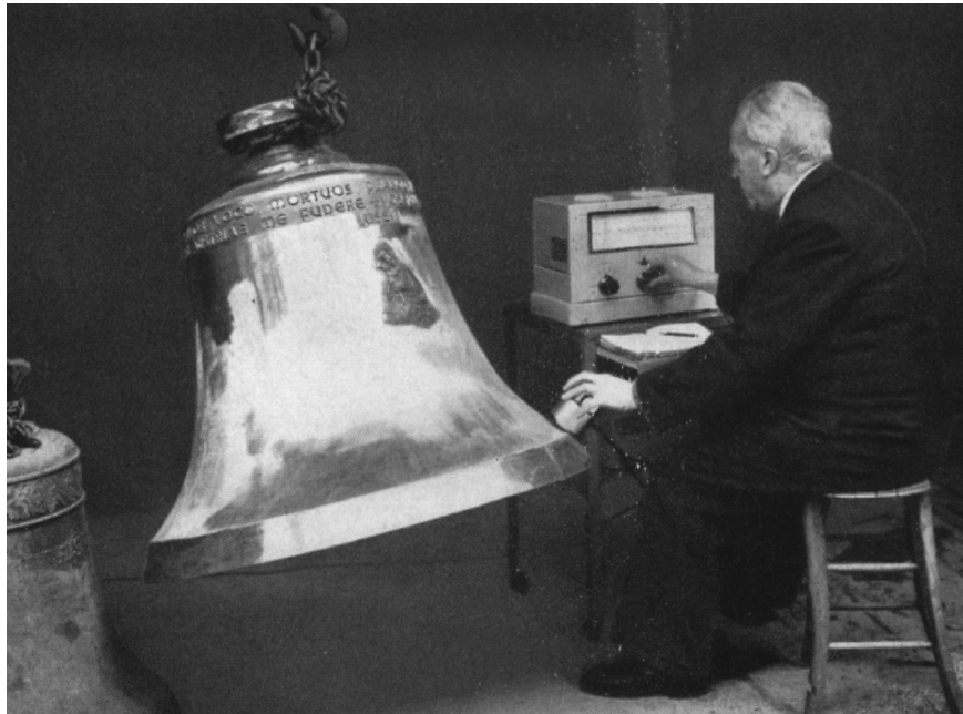
Abb. 2: Experimentelle Fourieranalyse, ca. 1960. Feststellung der Teiltöne mit elektrischem Abstimmgerät.
